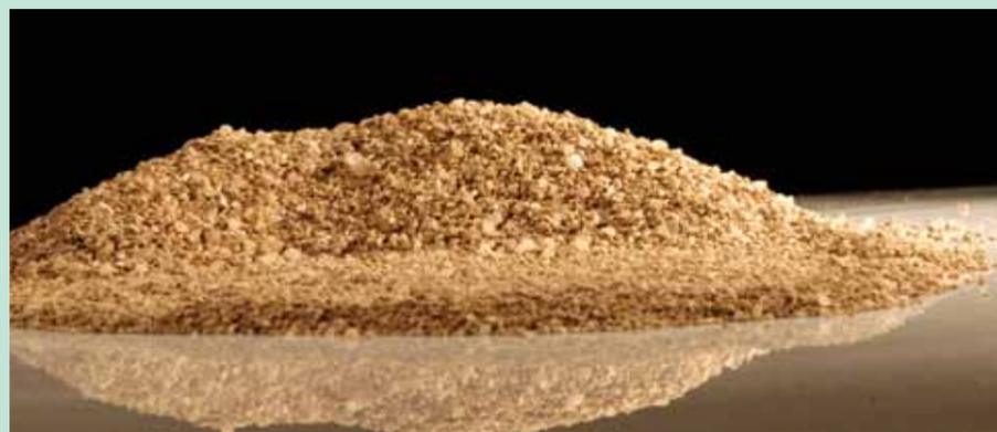
Le peculiarità del prodotto si contraddistinguono per granulometria costante e omogeneità delle particelle, assenza di fenomeni di de-miscelazione e assenza
